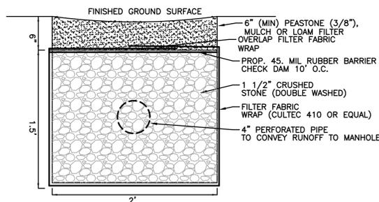
**CRUSHED STONE TRENCH DRAIN**
